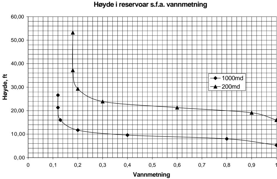
Figur 1: Høyde i reservoaret s.f.a. vannmetning for to bergartstyper, en med permeabilitet 200 md og en med 1000 md.
